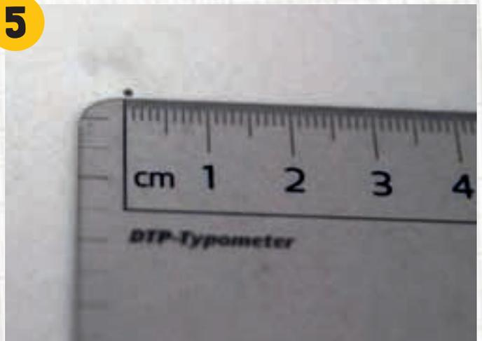
Jeder der Microdots ist knapp einen Millimeter groß und hauchdünn. Kaum zu glauben, dass darauf etwa 13 Zeilen mit Buchstaben Platz haben. Lesbar sind die allerdings nur von einer Seite – deshalb ist es wichtig, gleich mehrere Microdots am Markierungsobjekt anzubringen, um eine möglichst große Chance zu haben, mindestens eines in lesbarer Lage anzubringen
