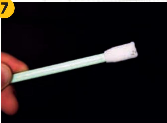
Im Idealfall sollten beim Aufbringen mehrere Microdots im Lack enthalten sein. Es ist jedoch wichtig, nicht zu viel UV-Lack aufzutragen, weil dieser beim Austrocknen sonst Blasen werfen oder deutlich sichtbar bzw. schaumig werden kann. Wurde der Lack zu dick aufgetragen, lässt sich der eingeschlossene Microdot zudem nicht mehr ablesen. Weniger ist mehr!
